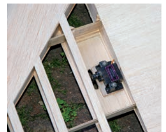
In alto, Alberto Dotti nel '60 col suo Avro 707 costruito partendo dal disegno pubblicato su "Scienza e Vita" (qui sopra). A fianco, un particolare di un servo degli elevoni e qui sotto il "cuore" del modello costituito dal complesso ventola-motore installato sul condotto dell'aria che somiglia ad un violino. A destra, il ventre del modello finito prima della copertura.
